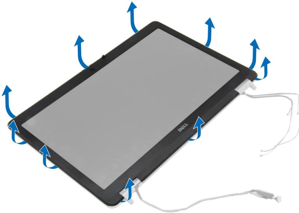
4. Extraiga el embellecedor de la pantalla del ensamblaje de la pantalla.
