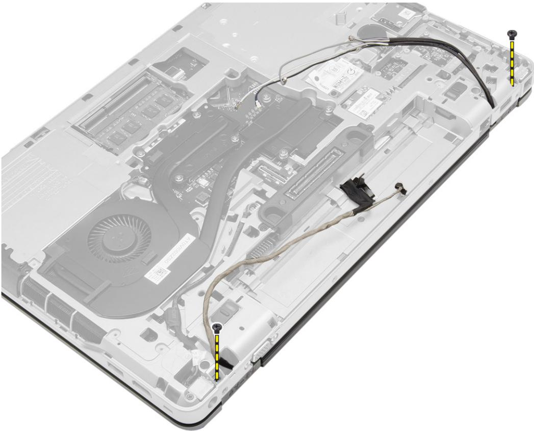
6. Extraiga del equipo el ensamblaje de la pantalla.
