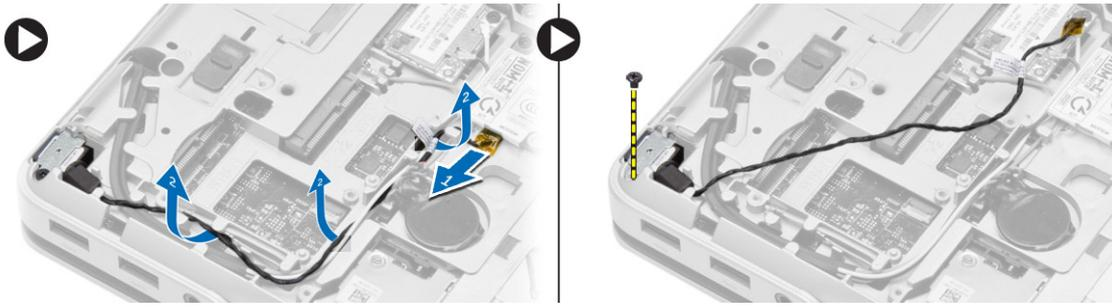
4. Levante el soporte del conector de red del equipo. Levante el conector de red del equipo.
