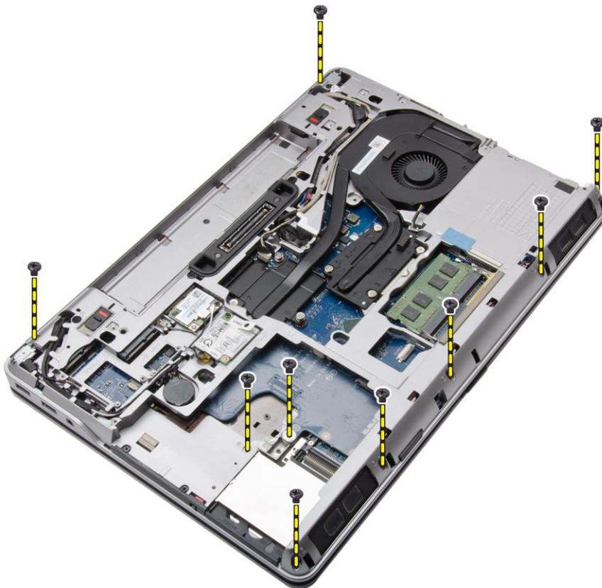
4. Dé la vuelta al equipo y quite los tornillos que fijan el ensamblaje del reposamanos al equipo.
