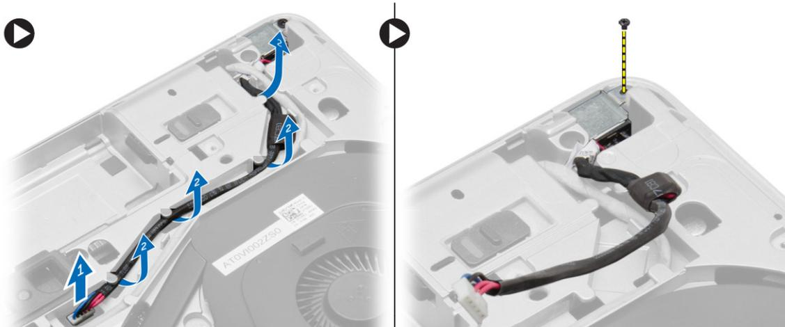
4. Levante el soporte del conector de alimentación del equipo. Levante el conector de alimentación del equipo.
