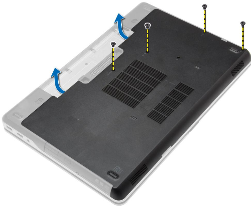
4. Levante la cubierta de la base y extráigala del equipo.
