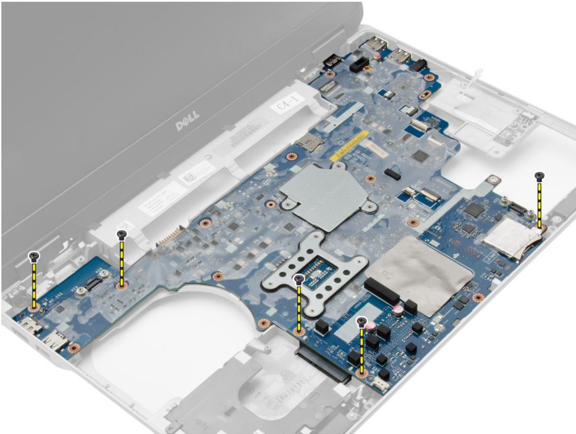
5. Levante y extraiga la placa base del equipo.
