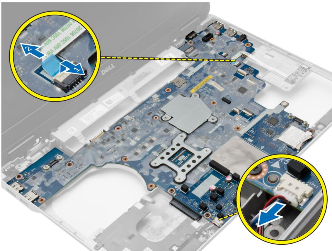
4. Extraiga los tornillos que fijan la placa base al equipo.
