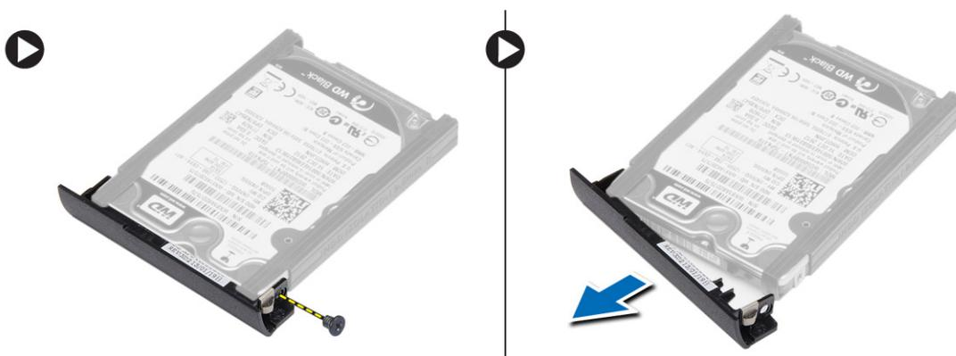
5. Flexione el aislamiento de la unidad de disco duro. Despegue el aislamiento de la unidad de disco duro de la unidad de disco duro.
